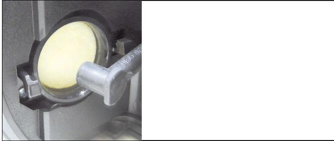
4. Sustituir el filtro usado por otro nuevo.
