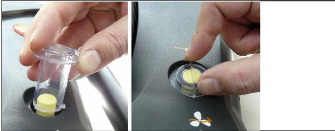
3. Colocar la tapa del filtro y cerrar girando en el sentido de las agujas del reloj. La muesca transversal de la tapa del filtro tiene que quedar paralela al mango.
