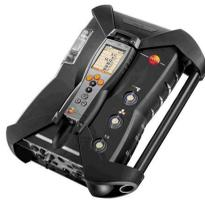
La Control Unit puede acoplarse a la caja analizadora.
