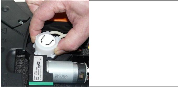
2. Desencajar ambos cierres de clip laterales de la bomba de condensados y levantar el cabezal de la bomba.
