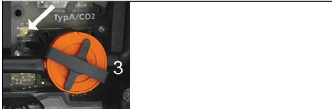
3. Mantener apretado el botón del contacto 3 mediante una herramienta puntiaguda con cuidado.
