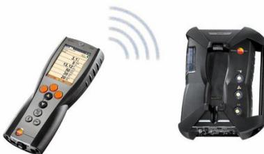
La Control Unit se puede conectar con una caja analizadora o con un portátil o PC mediante Bluetooth®, siempre y cuando ambos componentes dispongan de esta función, véase **Bluetooth®**, página 57.
