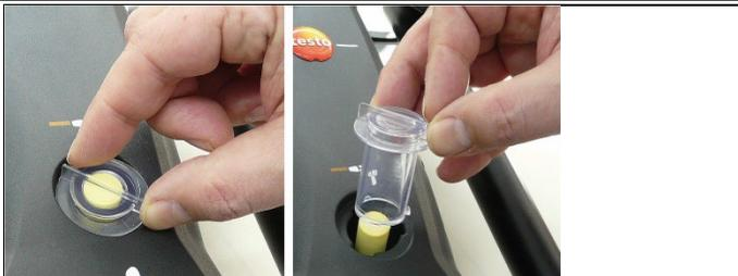
1. Abrir la cámara del filtro: Girar la tapa del filtro en sentido contrario a las agujas del reloj y retirar.
