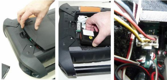
1. Abrir la tapa del compartimento de servicio (cierres de clip) situada en el lado trasero de la caja analizadora.
