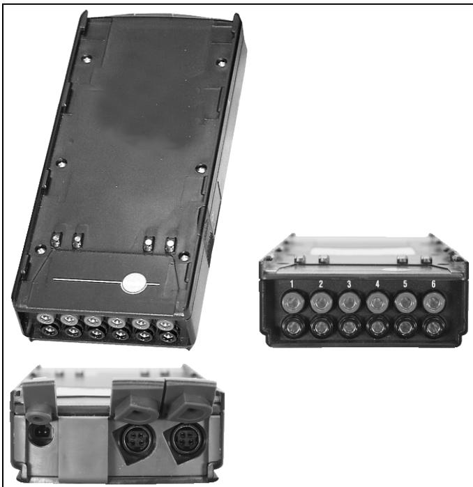
A través de la caja de salida analógica 0554 3149 (accesorio) se pueden emitir hasta 6 canales de medición como señal analógica (de 4 a 20 mA). La caja de salida analógica se conecta con el dispositivo mediante el bus de datos; la configuración puede realizarse mediante la Control Unit.
